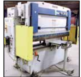
45 TON X 6' LVD 45 JS06-T PRESS BRAKE
